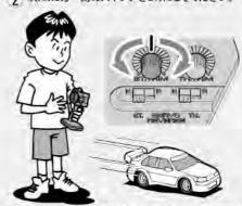
ステアリングを使わず走らせてみます。まっすぐ に走らない場合はステアリングトリムを使って調 節してください。 4
